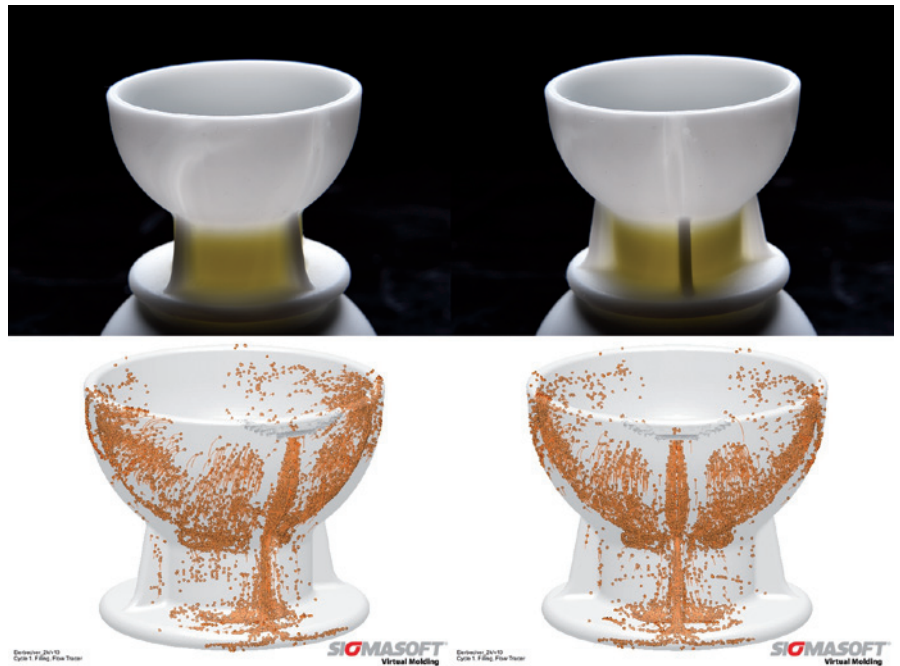
Abb. 7: Sowohl die vorhergesagte Bindenaht, an der die Schmelze in der Mitte zusammen-trifft (re.), als auch die Fließnähte in Verlängerung der seitlichen Stege (li.) finden sich auch in den realen Bauteilen wieder.
